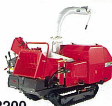
SR200 20PSディーゼルエンジン 最大処理径:チップ/130mm シュレッダ/65mm 自動送り制御付
